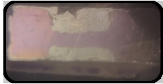
Figura 2: Canal definido por el etching químico.
